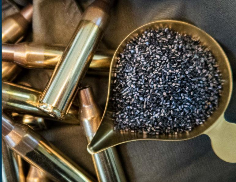
Die N500-Serie der Treibladungspulver von Vihtavuori liefert höchste Leistung für höhere Geschwindigkeiten und weitere Entfernungen bei schweren Geschossen. Dem traditionellen einbasigen Pulver wurde Nitroglyzerin zugesetzt, um einen höheren Energiegehalt zu erzielen. Die Serie bietet acht verschiedene Wiederladepulver mit unterschiedlichen Abbrandraten.
